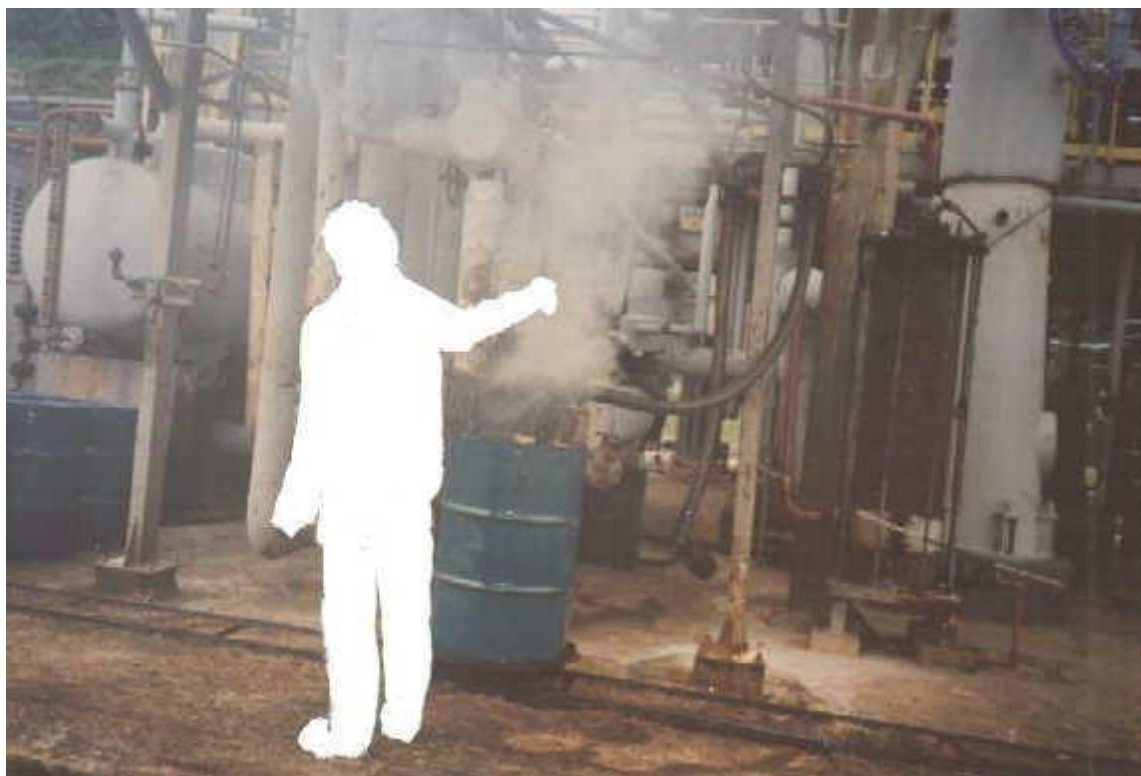
Figura 21 - Trabalhador na operação de drenagem do HCB
