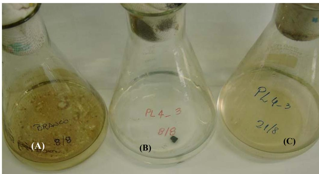
**Figura 4.2:** (A) representa o controle, sem adição de bactérias. (B) e (C) mostram os estágios de degradação do óleo após duas e uma semana de incubação, respectivamente.
