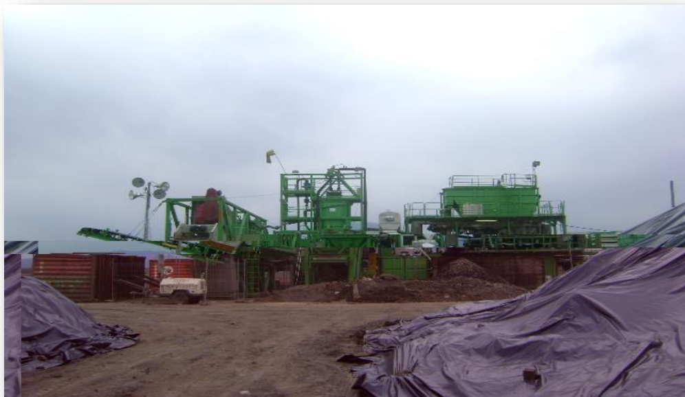
Figura 12 – Sistema de lavagem de solo operando na cidade de Santos quando da descontaminação do Lixão da CODESP
